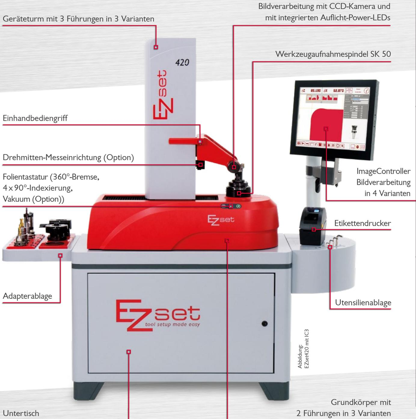
EZset-Werkzeugvoreinstellgeräte sind mit verschiedenen Messbereichen sowie den vier Bildverarbeitungsvarianten ICbasic, IC1, IC2 und IC3 erhältlich.
