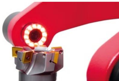
**Langlebige LED-Kaltlichtbeleuchtung** zur Schneidenspektion ist bei EZset-Werkzeuvoreinstellgeräten Standard.
