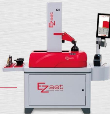
**1** Werkzeuge in das Werkzeugvoreinstellgerät einsetzen
