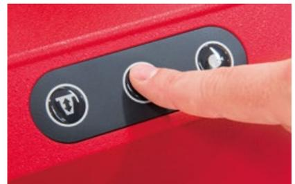
**Folientastatur** zur pneumatischen Betätigung von 4x 90°-Indexierung und Bremse der SK 50 Werkzeugaufnahmespindel. Optional mit Vakuumspannung.
