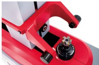
**Integrierte Kugelumlaufeinheiten** der Schlittenführungen garantieren lauffähiges, leichtgängiges Verfahren des Optikträgers für wiederholgenaue Messergebnisse.
